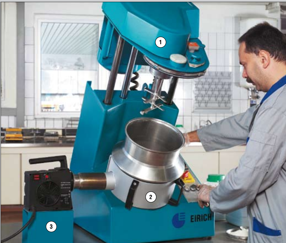
Abb. 5.1: R02VAC EVACTHERM®-Ex-Kleinanlage mit Mischreaktor (1), aufgesetztem Brüdenfilter (2), Kondensator mit integriertem Flüssigkeitsauffangbehälter (3) und Vakuumpumpenmodul mit Druckregelung (4)
