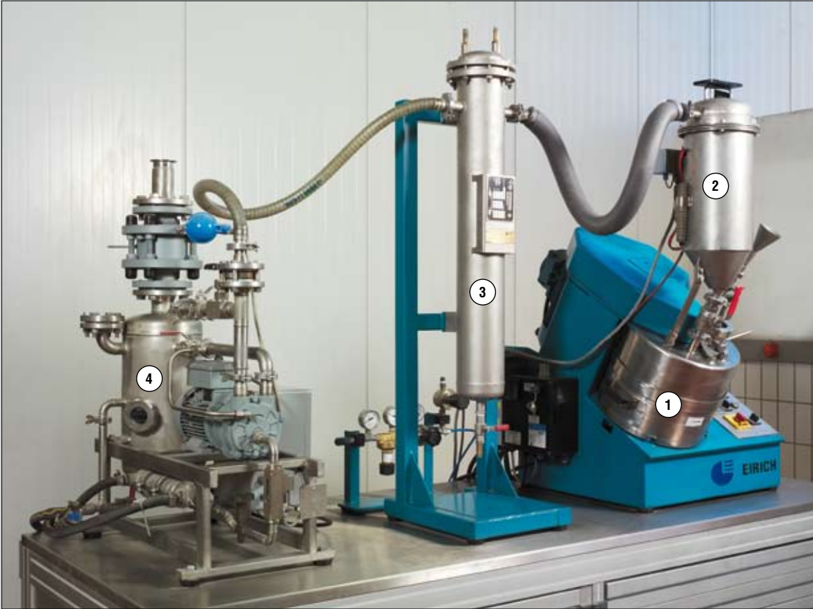
Abb. 5.1: R02VAC EVACTHERM®-Ex-Kleinanlage mit Mischreaktor (1), aufgesetztem Brüdenfilter (2), Kondensator mit integriertem Flüssigkeitsauffangbehälter (3) und Vakuumpumpenmodul mit Druckregelung (4)
